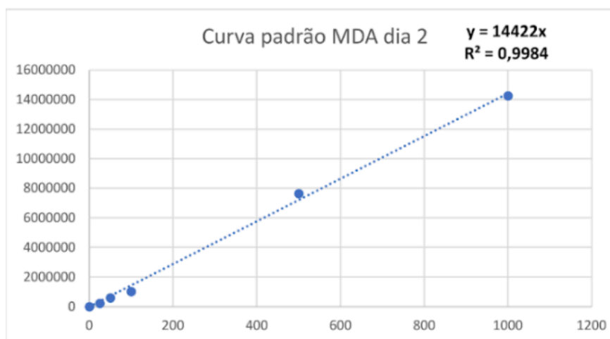
Figura 6: Curva padrão de MDA no HPLC, produzida no dia 2.
