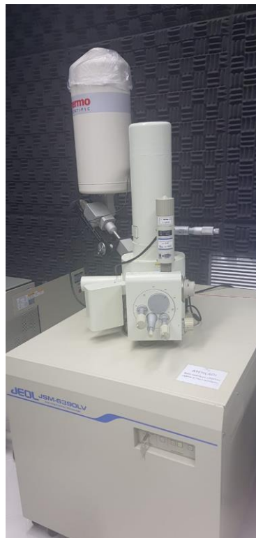
Figura 6: Microscópio eletrônico de varredura do Laboratório Central de Microscopia Eletrônica
