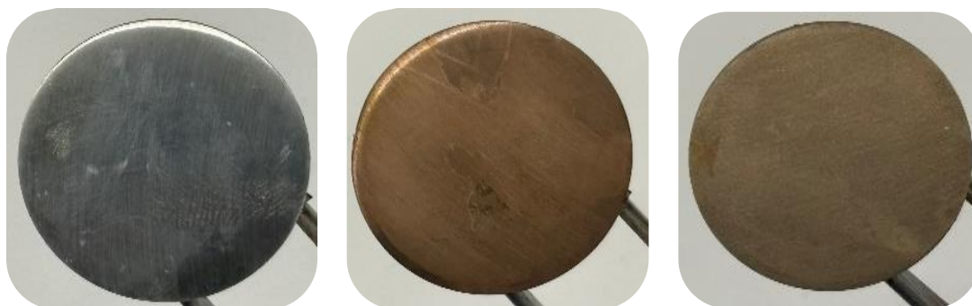
Figura 10: Moeda de Mg puro, Mg pré-tratado e Mg com revestimento de pectina, respectivamente
