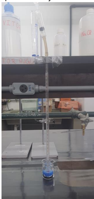
Figura 9: Sistema para a medição da liberação de hidrogênio
