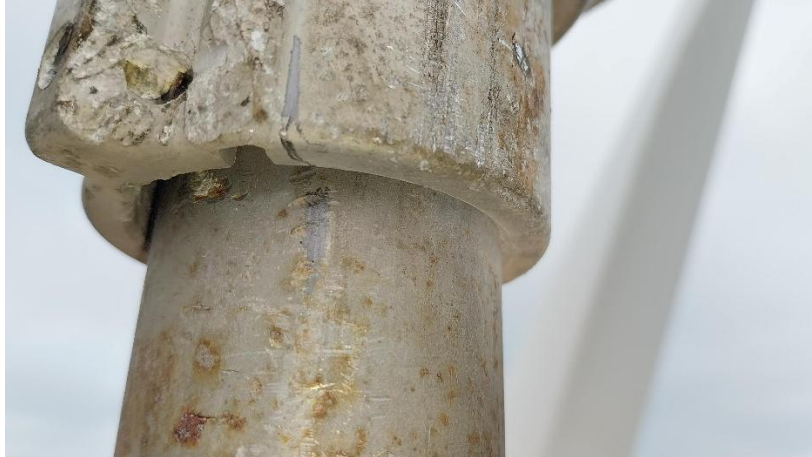
Figura 29 – Suporte do anemômetro após rotação para \Delta\varphi especificado.
