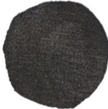
Figura 17 – Amostra revestida após ensaio de formação de pilling por intermédio do equipamento Pilling box
