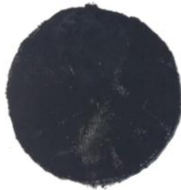
Figura 13 – Amostra revestida com PPy após 15 ciclos de lavagem.
