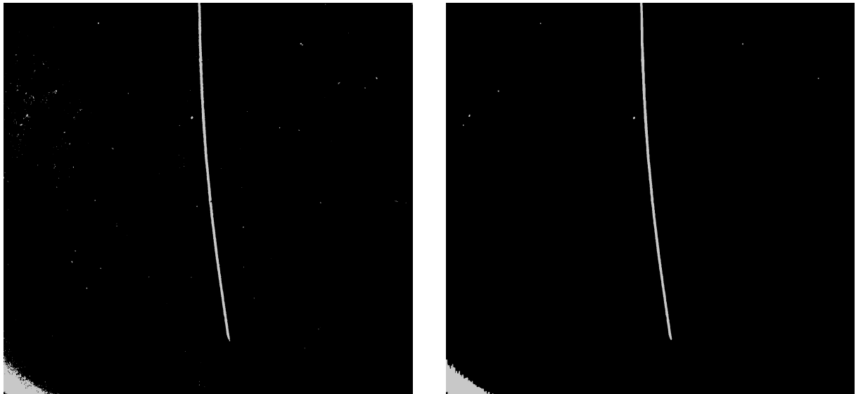
Figura 13 – (a) Máscara binária obtida diretamente com o método global, apresentando ruído. (b) Máscara final após a aplicação das operações morfológicas de abertura e fechamento, pronta para a análise.
