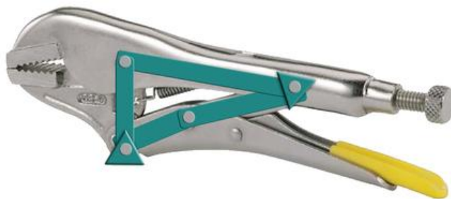
Figura 2 – Mecanismo de quatro barras de um alicate de pressão
