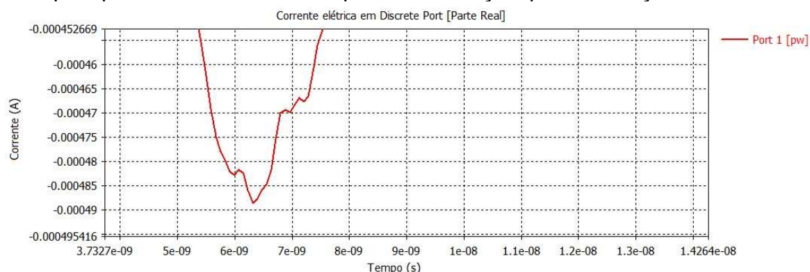
Figura 45 - Pico da curva de corrente elétrica para frequências de 2,0 a 3,0 GHz e espiral plano. Port 1 é nome do ponto de medição. pw é indicação de Port wave
