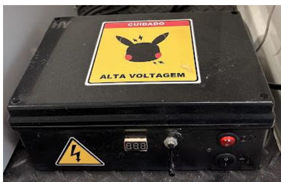
Figura 7- Equipamento de eletrofiação, imagem à esquerda fonte de alta tensão, e imagem à direita composta pela bomba de infusão e pelo coletor metálico.
