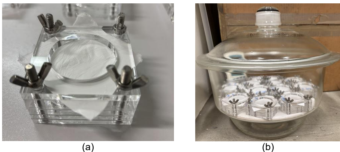
Figura 9- (a) membranas eletrofiadas de ZnO e ZnO:5%Ag fixadas nas células de acrílico, (b) dessecadora com ambiente úmido
