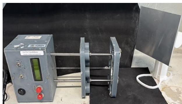
Figura 7- Equipamento de eletrofiação, imagem à esquerda fonte de alta tensão, e imagem à direita composta pela bomba de infusão e pelo coletor metálico.
