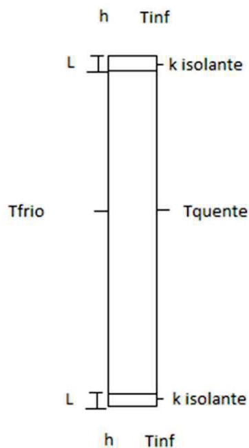
Figura 22 - Esquema do modelo numérico do medidor de Fator Solar.
