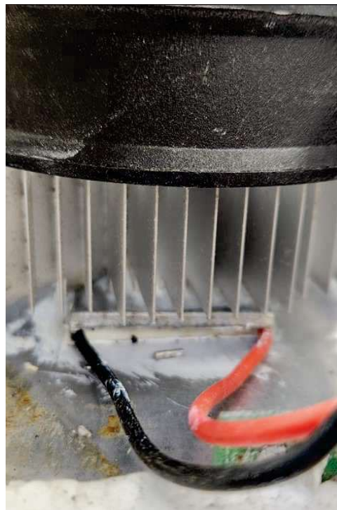
Figura 12 - Detalhe pastilha Peltier e trocador de calor.
