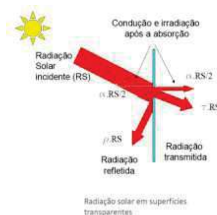
Figura 1 - Condução e irradiação após absorção. Fonte: Lamberts, 2004.
