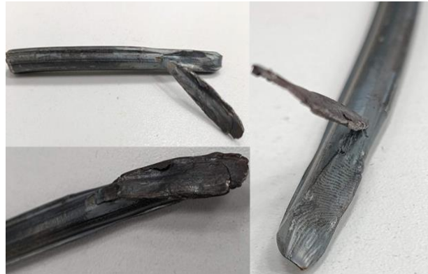
Figura 26: Exemplo de rompimento no fio máquina durante laminação à quente, do aço 1018 (SAE 1020).
