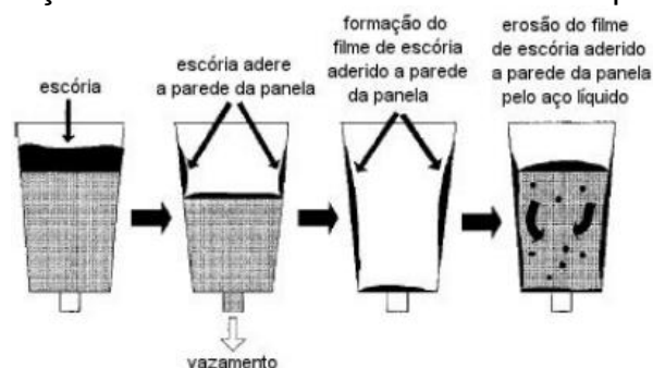
Figura 22: Formação da camada de escória aderida à parede da panela.
