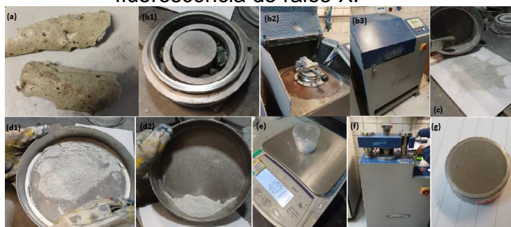
Figura 38: Preparação da escória do forno panela para análise química por fluorescência de raios-X.
