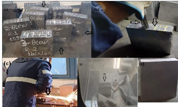
Figura 31: Preparação das amostras de aço para análises quantitativas de macro-inclusões.
