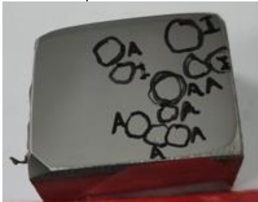
Figura 36: Amostra após preparação metalográfica, com identificação das regiões contendo porosidade e inclusões.
