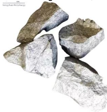
Figura 13: Ferro silício 75% granulado, utilizado como desoxidante.
