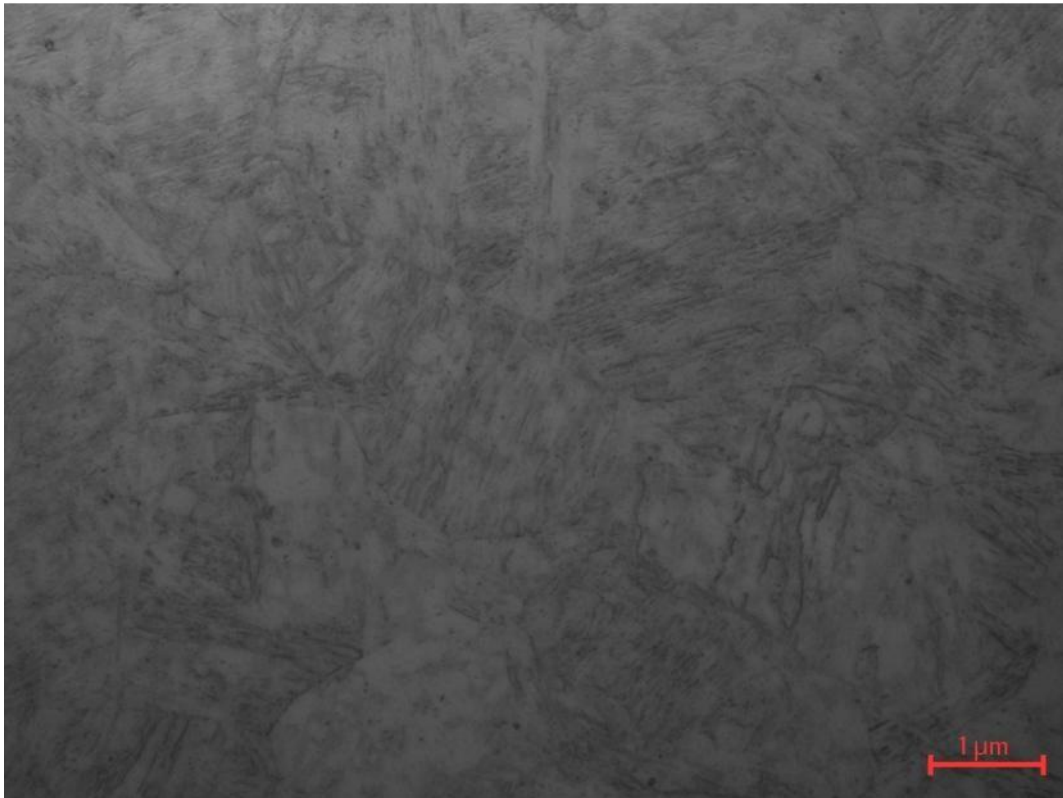
Figura 6 - Microestrutura do Aço inox 420 após tempera a 1038°C. Ampliação de 500x
