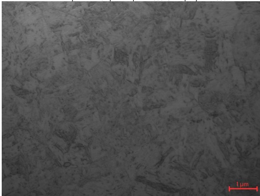
Figura 7 - Microestrutura do Aço inox 420 após tempera a 998°C. Ampliação de 500x.
