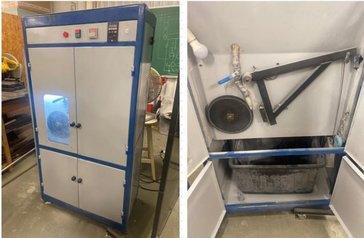
Figura 8 - Vista frontal da máquina de abrasão por roda de borracha conforme ASTM G65, utilizada para avaliar a resistência ao desgaste das amostras
