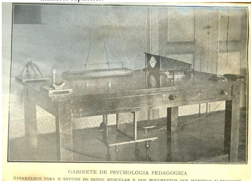
Figura 18 – Aparelho para o estudo do senso muscular e dos movimentos dos membros superiores.
