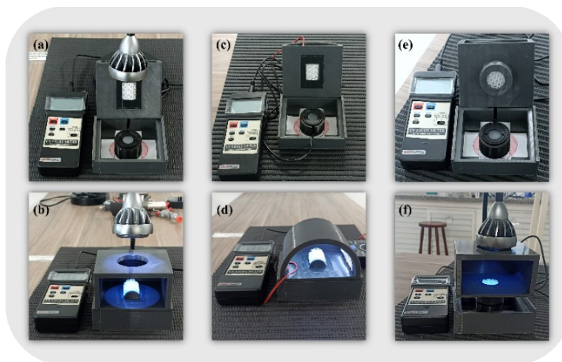
Figura 4.6 – Ensaios radiométricos para avaliação da distribuição de intensidade luminosa na relação entre arranjos de iluminação (a, b – Point light lateral ; c, d – Flood light circunferencial ; e, f – Point light frontal ) e geometrias de suportes poliméricos usados como fotocatalisadores
