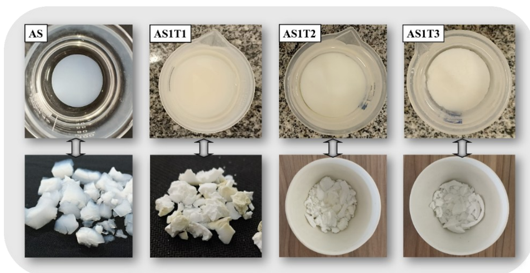
Figura 5.1 – Alcolgéis (superior) e aerogéis (inferior) secos de sílica nativa (AS) e compósitos de sílica-titânia com diferentes proporções molares de Si:Ti (AS1T1, AS1T2 e AS1T3)
