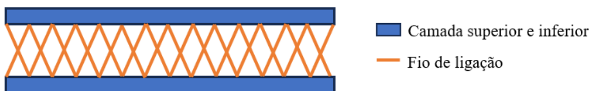
Figura 3 – Esquema ilustrativo de uma malha spacer .
