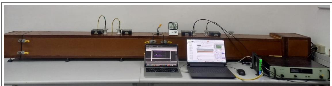
Figura 59: Tubo de impedância de seção transversal quadrada construído para avaliar o comportamento do MA ventilado.
