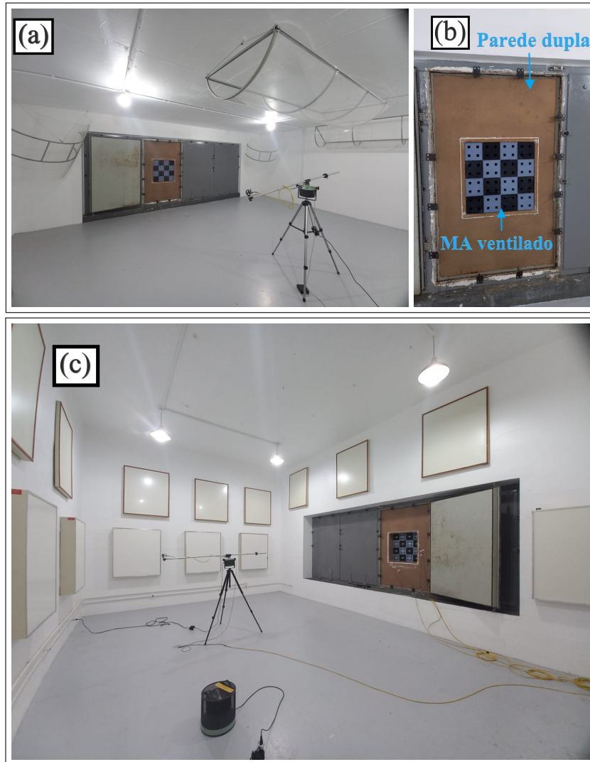
Figura 67: Teste realizado nas câmaras reverberante do LVA da UFSC. (a) Perspectiva da câmara emissora. (b) Painel acoplado na janela. (c) Perspectiva da câmara receptora.
