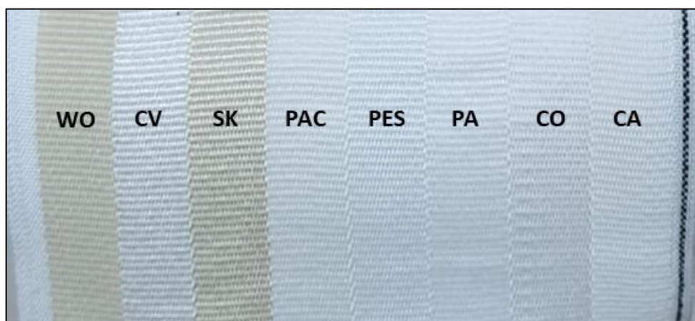
Figura 18 – Tecido multifibras antes de ser cortado e costurado nos corpos de prova para o teste de solidez à lavagem
