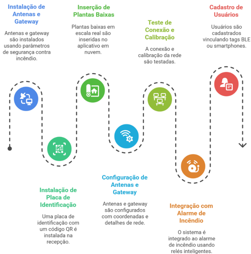
Figura 10 – Fluxo da integração dos componentes do sistema de gestão de evacuação de emergência.
