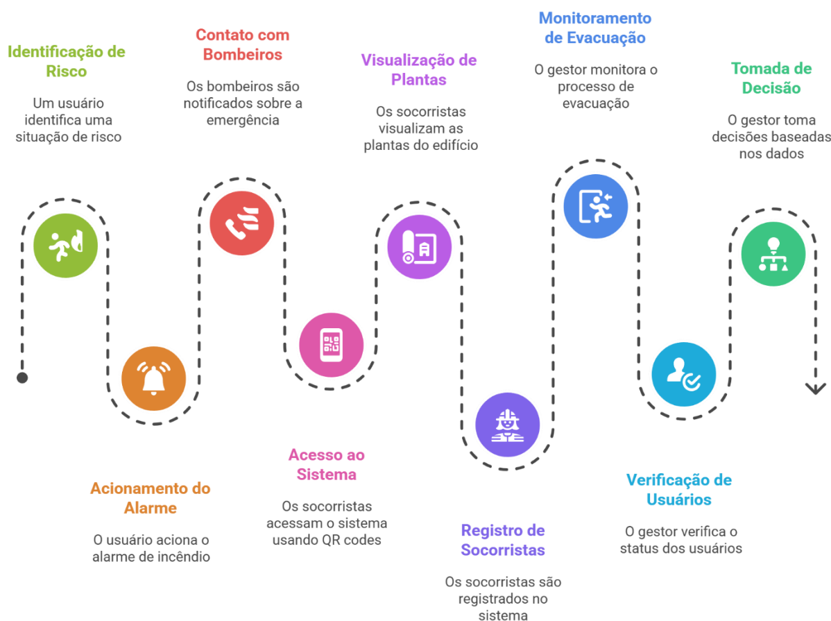
Figura 14 – Fluxo da operação do sistema de gestão de evacuação de emergência.
