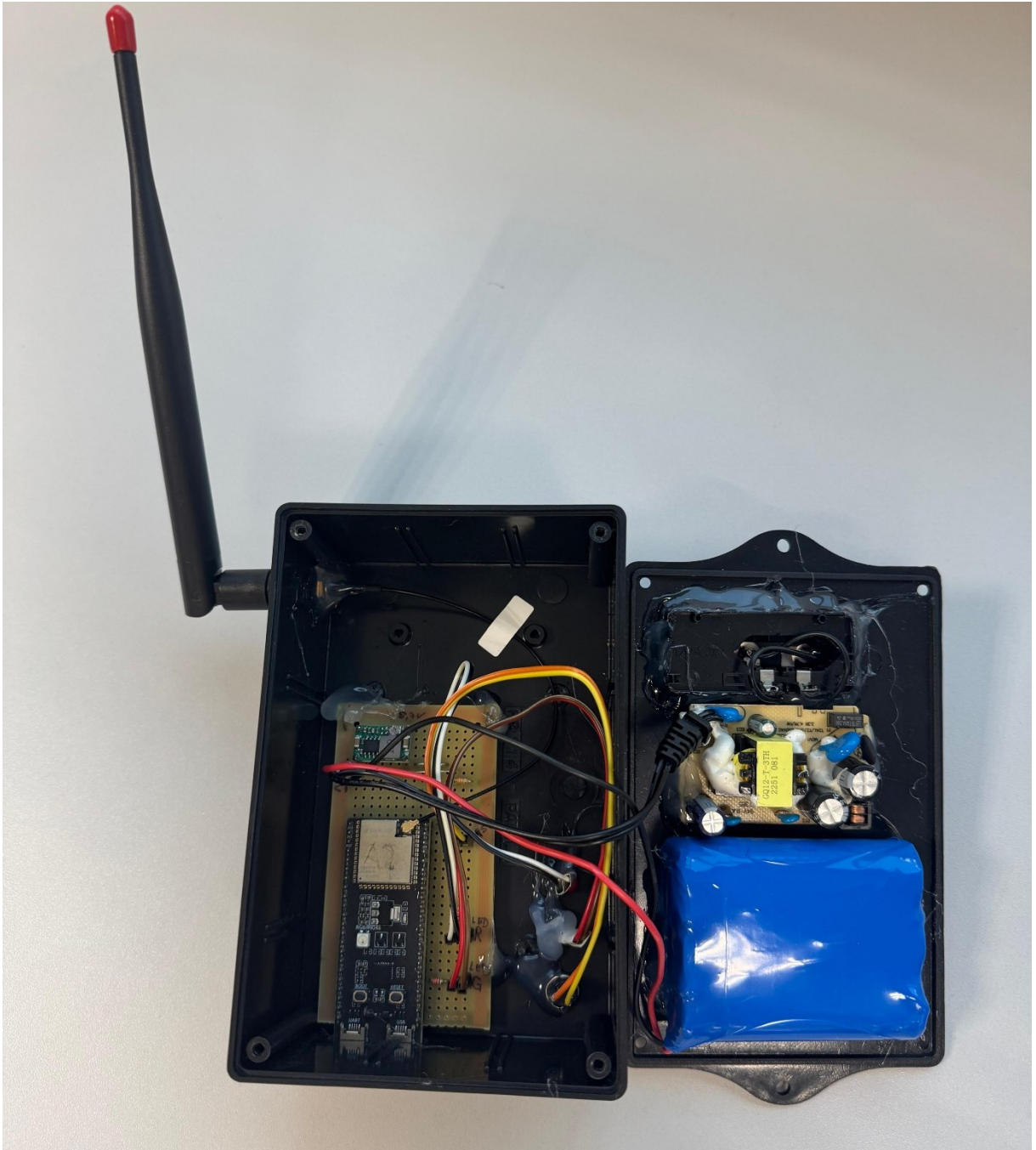
Figura 23 – Componentes instalados no gabinete de ABS.
