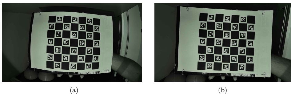
Figura 16 – (a) Vista da câmera com distorção da lente. (b) Vista da câmera sem distorção da lente.
