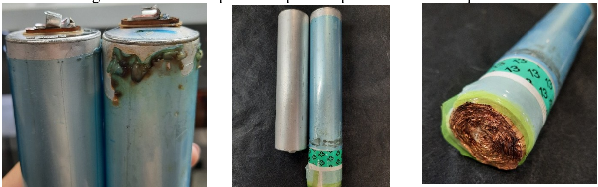
Figura 47 - Células expandidas após ultrapassar limite de temperatura.
