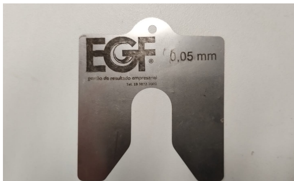
Figura 17 – Calço metálico de 0.05 mm.
