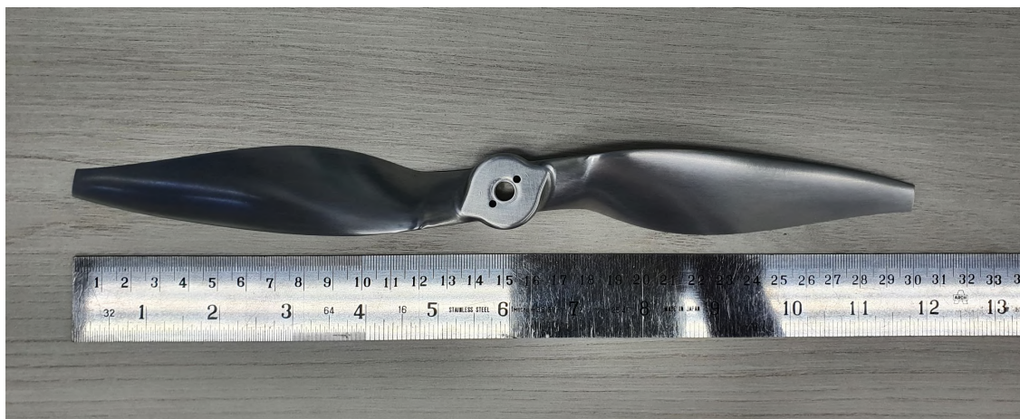
Hélice de Delft usinada.
