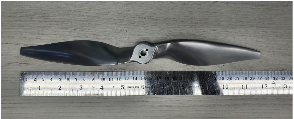
Figura 18 – Hélice de Delft usinada.
