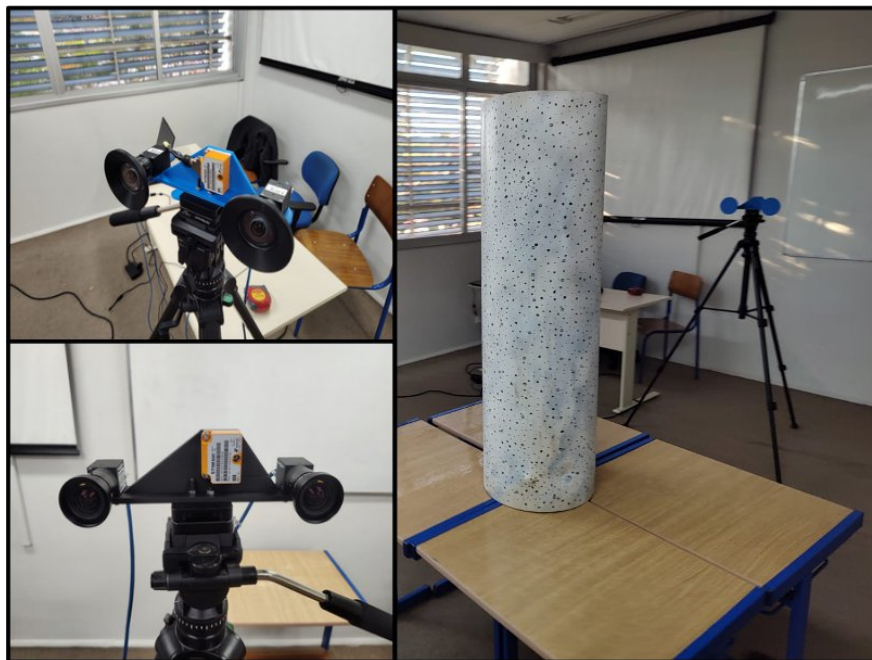
Figura 30 – Corpo de prova (tubo polimérico) e arranjo experimental para avaliação da nuvem de pontos no LABMETRO.
