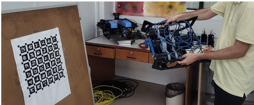
Figura 24 – Coleta de dados para calibração extrínseca Câmera-IMU.
