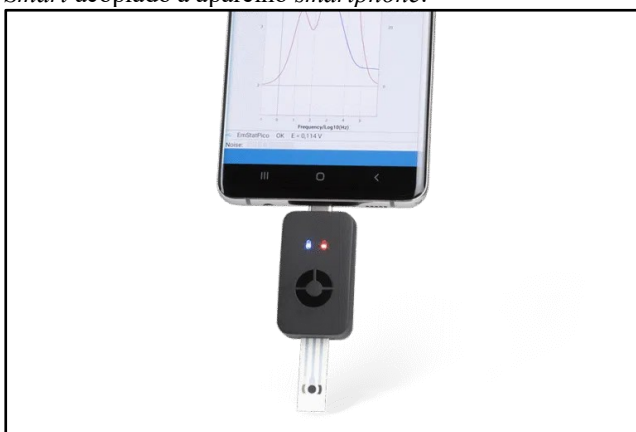
Figura 4. Potenciostato Sensit Smart acoplado a aparelho smartphone .
