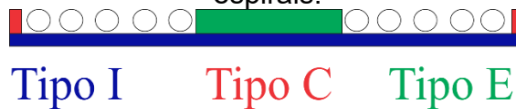
Figura 2.14 – Tipos de núcleo de ferrite que podem ser empregados em bobinas espirais.
