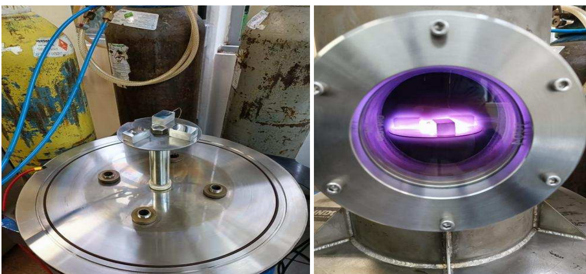
Figura 40 - (a) Amostras preparadas para nitretação e (b) Amostras em processo de nitretação a plasma
