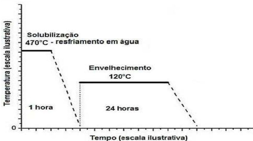
Figura 9 - Desenho esquemático do tratamento térmico T6 para liga de alumínio 7075.
