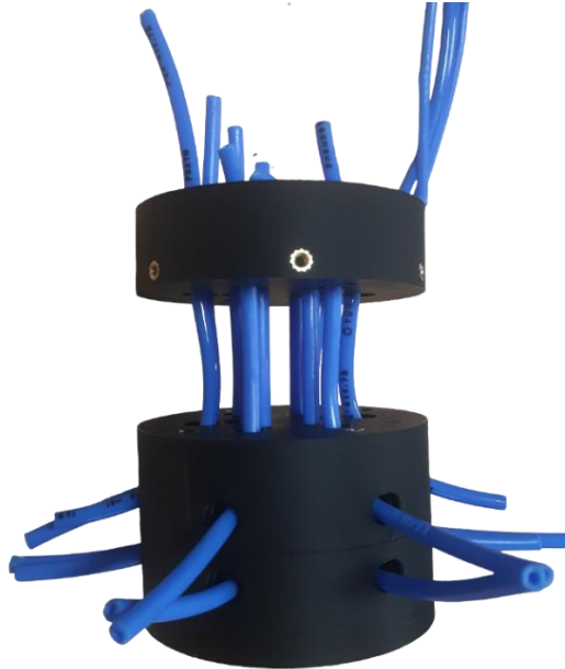
Figura 24: Tubos passando pelas seções da peça manufaturada.
