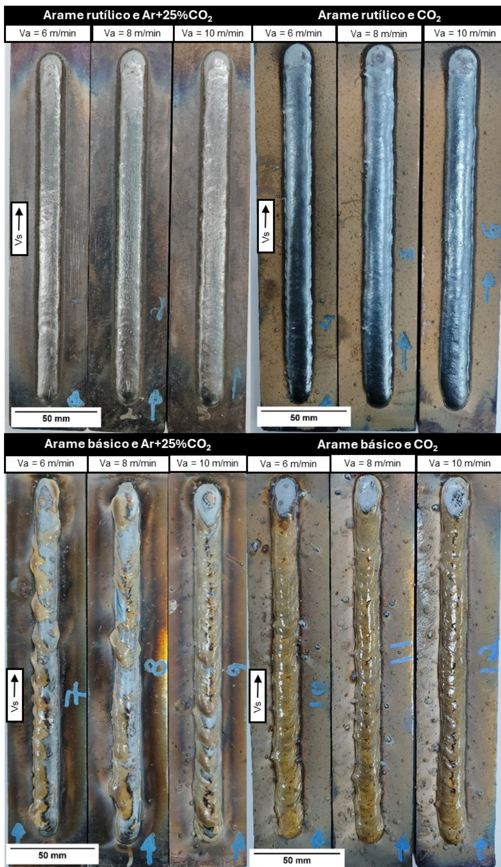
Figura 31 - Cordões de solda resultantes dos ensaios com arames com diâmetro de 1,2 mm - antes do processo de escovação
