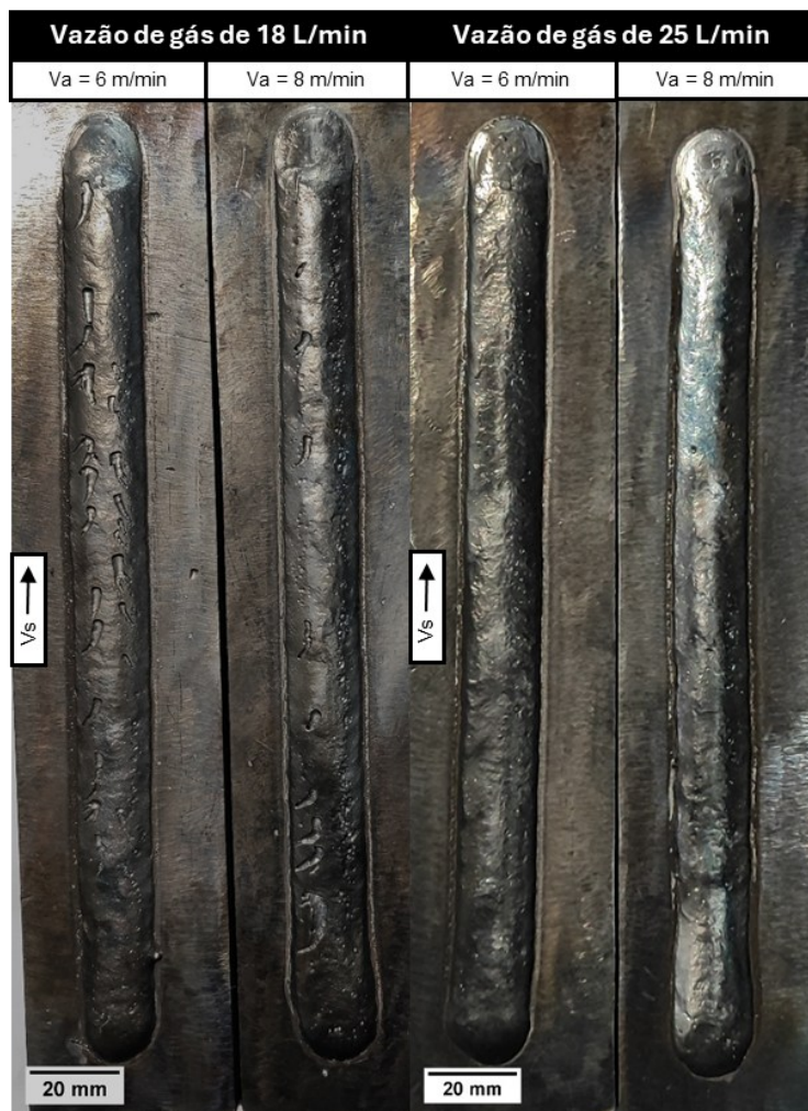
Figura 33 - Cordões de solda obtidos com arame rutílico com 1,6 mm de diâmetro e gás de proteção Ar+25% CO 2 nas vazões de 18 e 25 L/min
