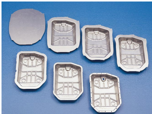
Figura 3 – Exemplo das etapas para fabricação de um cárter de óleo
