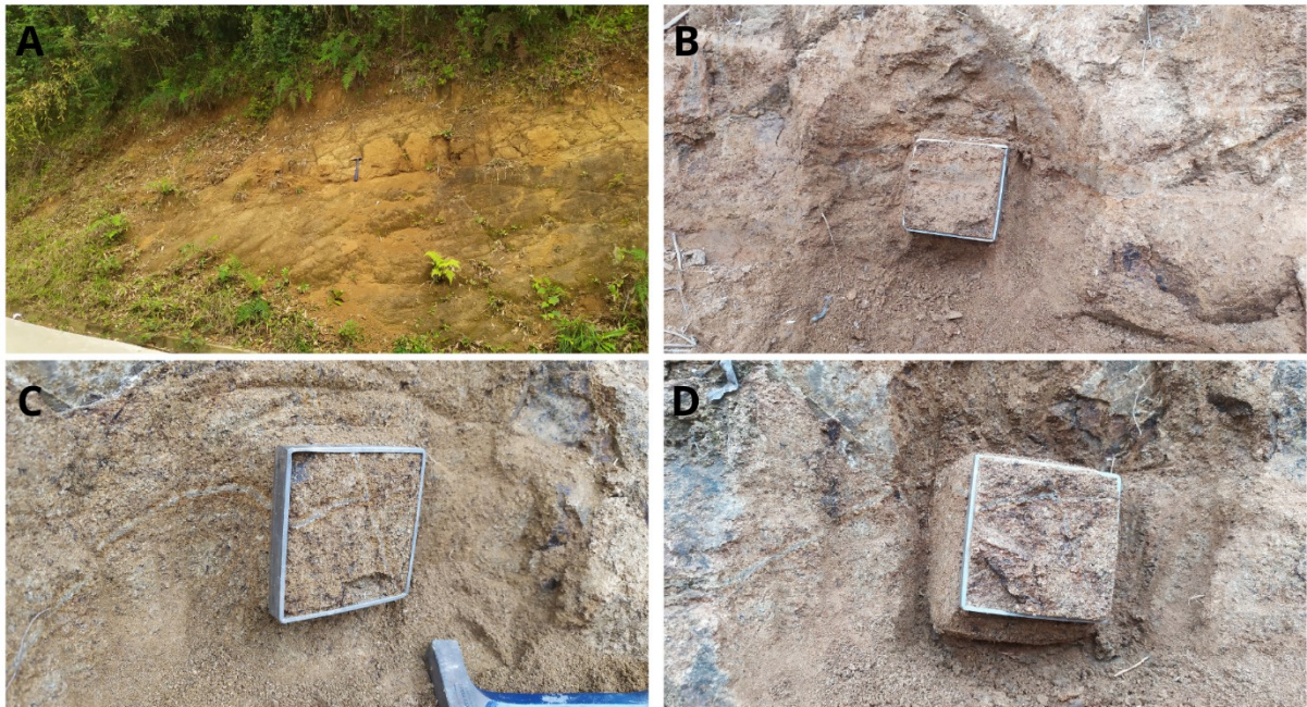
Figura 27 - Processo de coleta da amostra indeformada em campo. (A) Talude do local de amostragem. (B) Corpo de prova 1. (C) Corpo de prova 2. (D) Corpo de prova 3.
