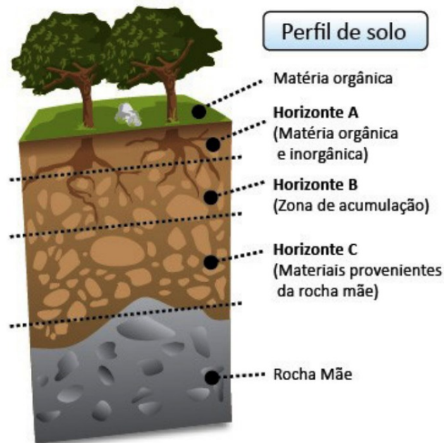
Figura 12 - Esquema dos horizontes do perfil do solo.
