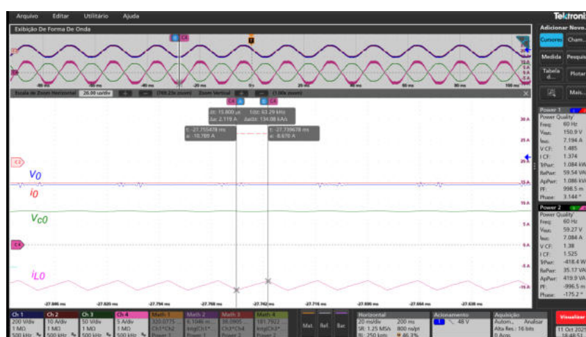
Figura 106 – Ondulação de corrente no indutor do filtro de saída — semiciclo negativo ( M < 0 ).
