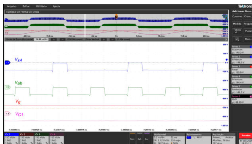
Figura 112 – Formas de onda detalhadas das tensões V_{S4} , V_g , V_{ab} e V_{C1} — semiciclo negativo da rede ( M < 0 ).
