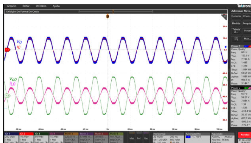
Figura 104 – Formas de onda das tensões e correntes medidas no ensaio com modulação negativa ( M < 0 ).
