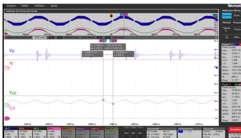
Figura 94 – Ondulação de corrente no indutor do filtro de saída — semiciclo positivo com M > 0 .
