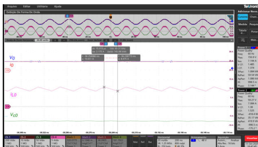
Figura 105 – Ondulação de corrente no indutor do filtro de saída — semiciclo positivo ( M < 0 ).
