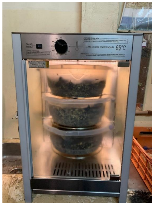
Figura 5: Microcomposteira UFSC em funcionamento.
