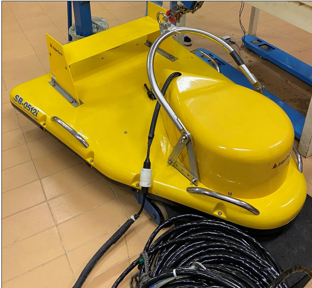
Figura 7 — Fonte acústica e receptor (interno), equipamento do tipo chirp EdgeTech, modelo 0512i.
