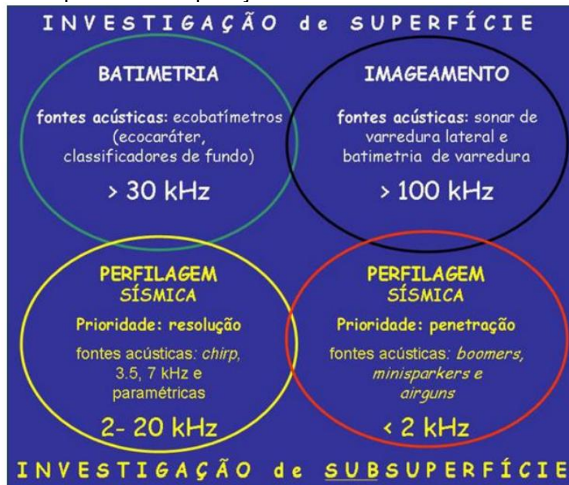
Figura 3 — Figura esquemática sobre métodos de investigação, seus objetivos, frequências de operação e modelo de funcionamento.
