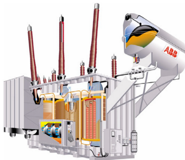
Figura 12 – Transformador de Potência. Fonte: Frontin (2013).
