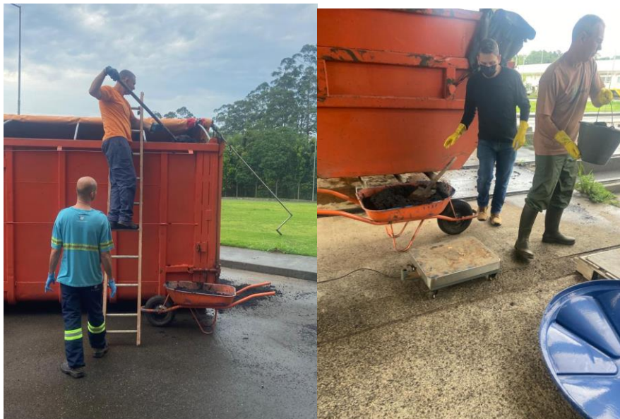
Figura 1. Coleta do lodo nos tanques de armazenamento na CAJ para posterior realização do processo de caleação.
