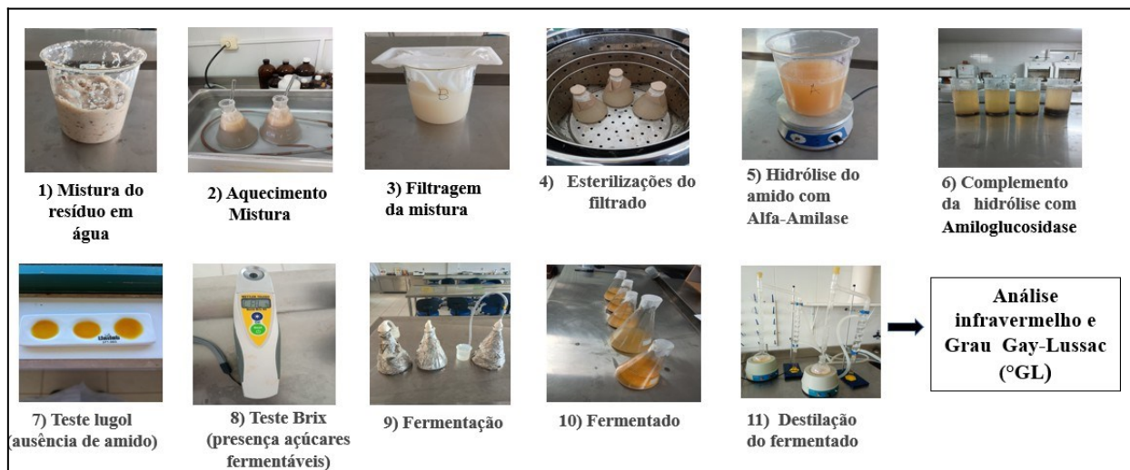
Figura 11 - Principais etapas da produção de bioetanol
