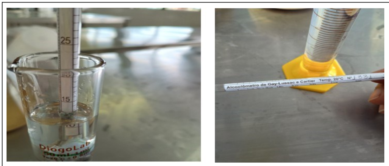
Figura 13- Registro fotográfico determinação de (°GL) por Densimetria
