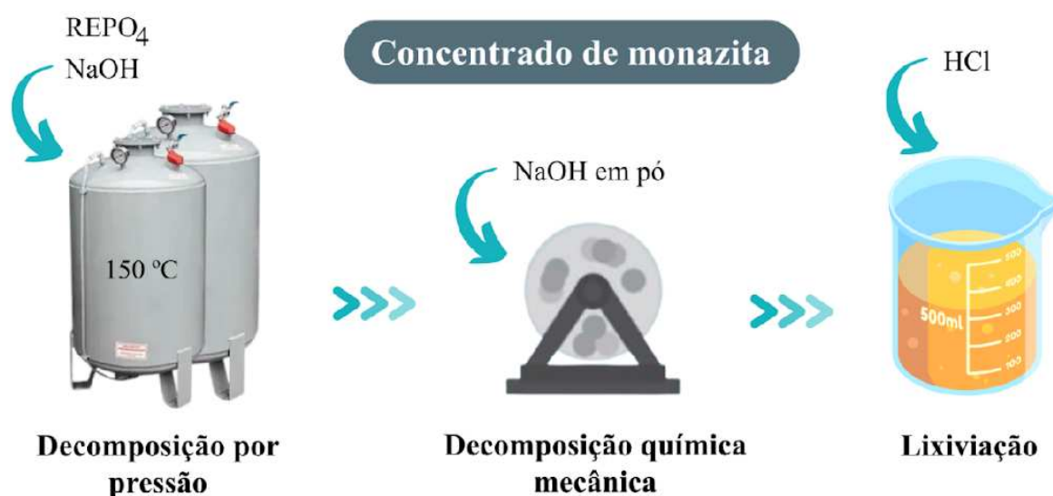
Figura 7. Esquema do processo de mineração da monazita em meio alcalino.
