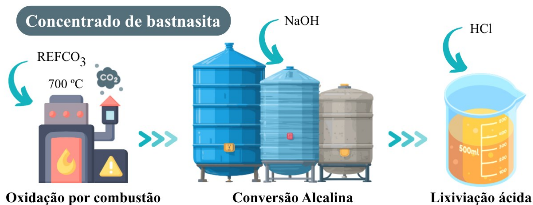
Figura 6. Ilustração do processo de calcinação, alcalinização (NaOH) e lixiviação ácida (HCl) de ETRs.
