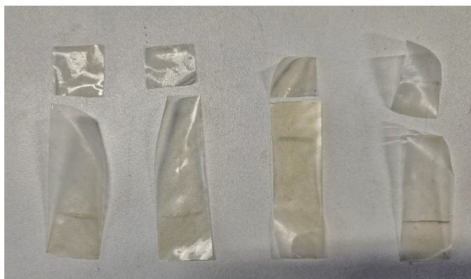
Figura 38 - Filmes EHECox4Q24 após ruptura
