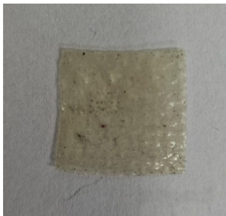
Figura 36 - Amostra do filme EHECox4Q24 após quatro meses de teste de biodegradabilidade em solo.
