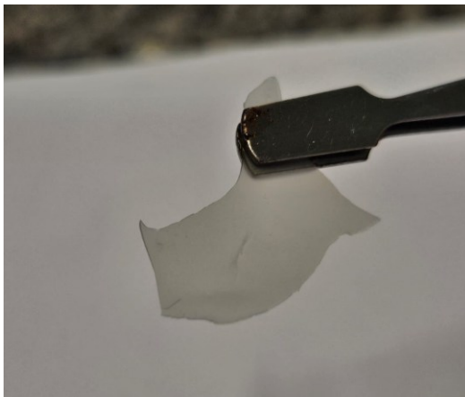
Figura 27 - EHECox4Q24 em solução alcalina submersa por cinco meses.
