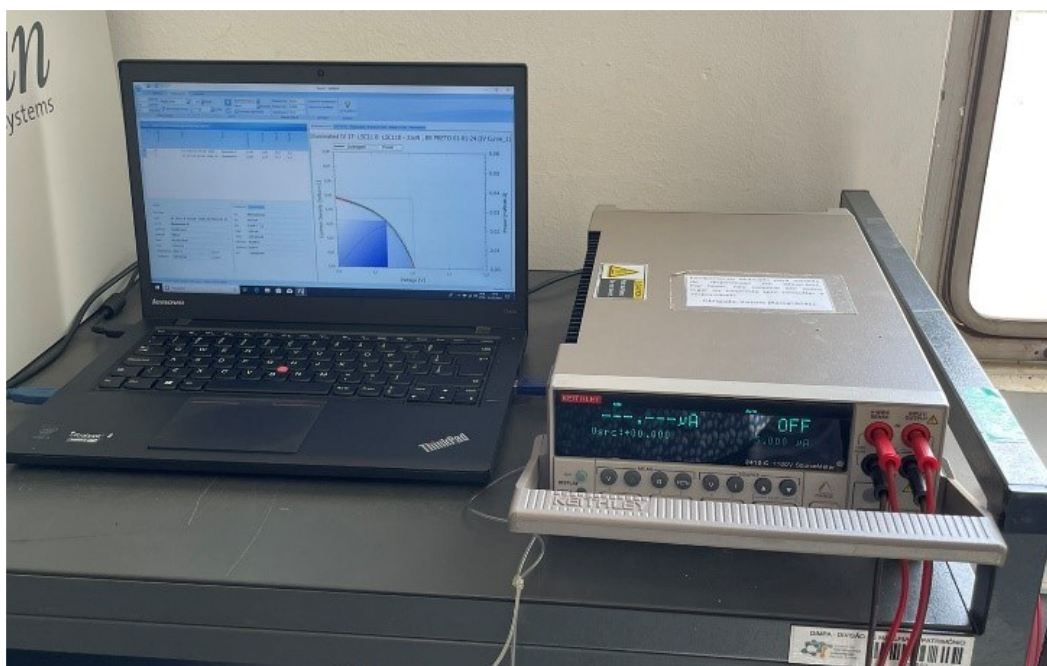
Figura 20 - Unidade de medição de tensão e corrente
