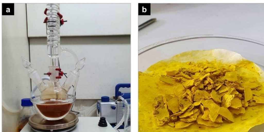
Figura 21. (a) Sistema utilizado para a nitração do Pireno, (b) imagem do produto da nitração 1,3,6-trinitropireno após a purificação e secagem
