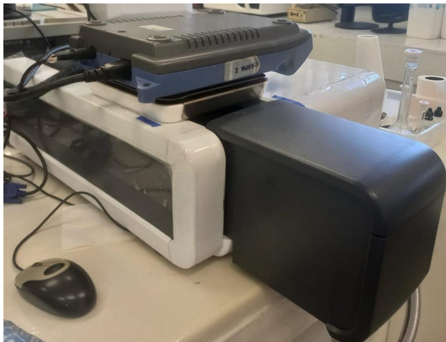
Figura 32: Representação da disposição do agitador magnético no equipamento Cary 60.
