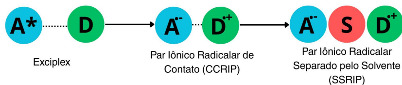
Figura 19 – Esquema figurativo mostrando a interação do solvente com o par iônico radicalar em contato (CRIP) formando o par iônico radicalar separado pelo solvente (SSRIP).
