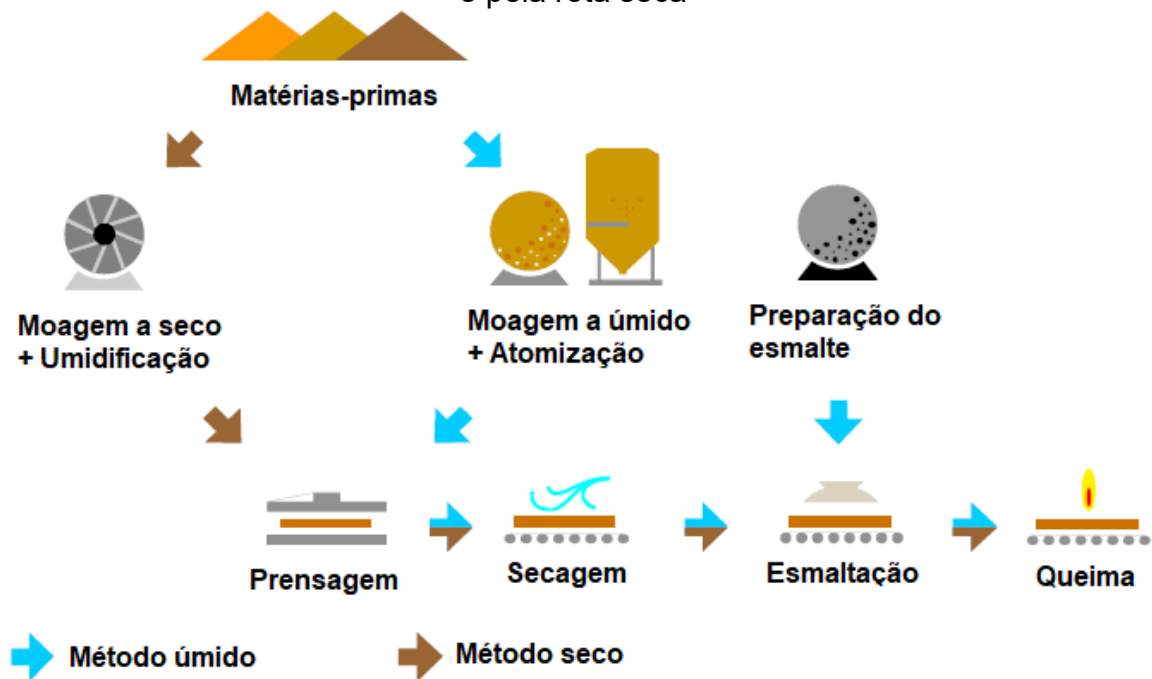
Figura 4 – Etapas do processo de produção de materiais cerâmicos pela rota úmida e pela rota seca
