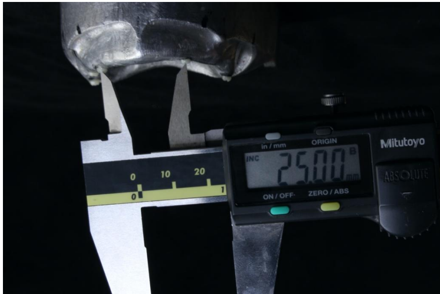
Figura 11. Medida aferida com um paquímetro digital no modelo-mestre. Fonte: Elaborado pela autora (2024).
