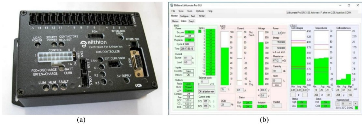
Figura 3 - (a) BMS utilizado no BESS em segunda vida; (b) Software do BMS.
