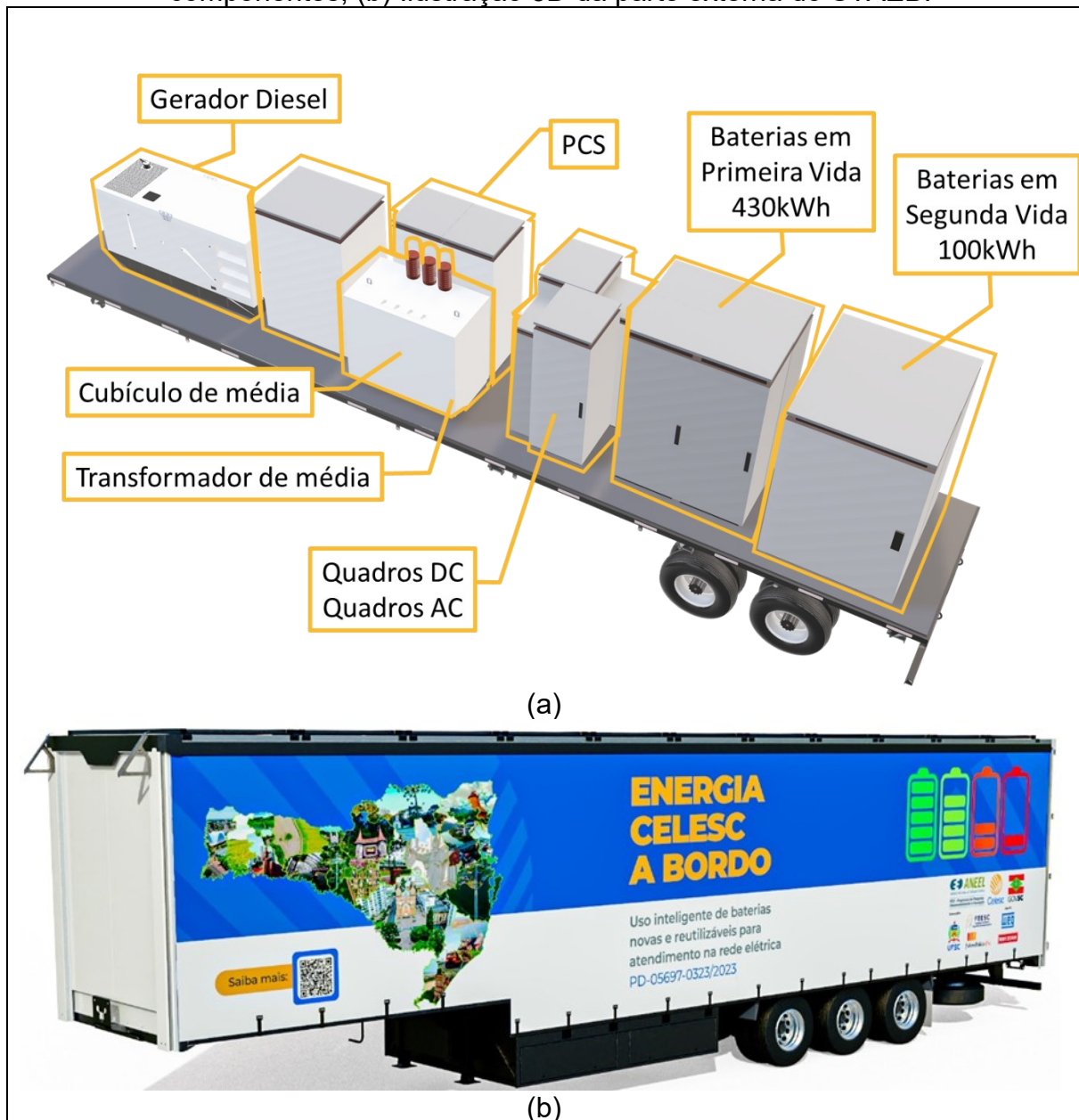
Figura 15 – (a) Imagem ilustrativa do STAEB e seus principais sistemas componentes; (b) Ilustração 3D da parte externa do STAEB.
