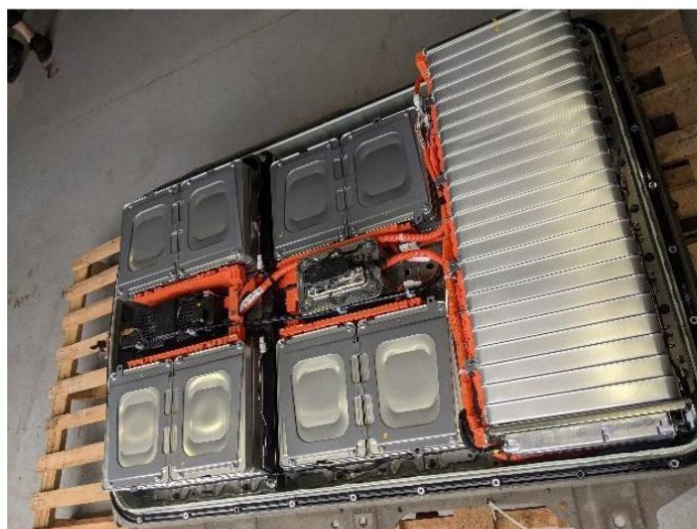
Figura 1 - Conjuntos de baterias do Nissan LEAF aberto (Hohmann; Oliveira; Rüther, 2022).
