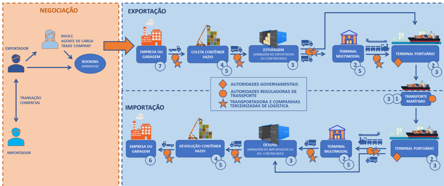
Figura 4 – Fluxo da carga através das infraestruturas e agentes da cadeia logística portuária.
