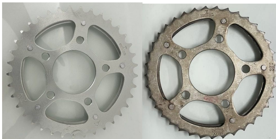
Figura 26 - Comparativo macroscópico da Amostra C: (a) estado inicial; (b) aspecto após o ensaio apresentando irregularidades geométricas e perda de simetria.
