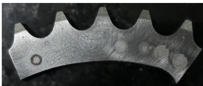
Figura 16 - Demonstração da execução das queimas por espectrometria de emissão óptica (OES).
