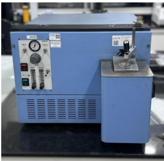
Figura 15 - Espectrômetro de emissão óptica (OES) utilizado na caracterização química das coroas.
