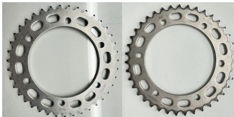
Figura 27 - Comparativo macroscópico da Amostra D: (a) estado inicial; (b) aspecto após 3.000.000 de ciclos com perfil geométrico preservado.
