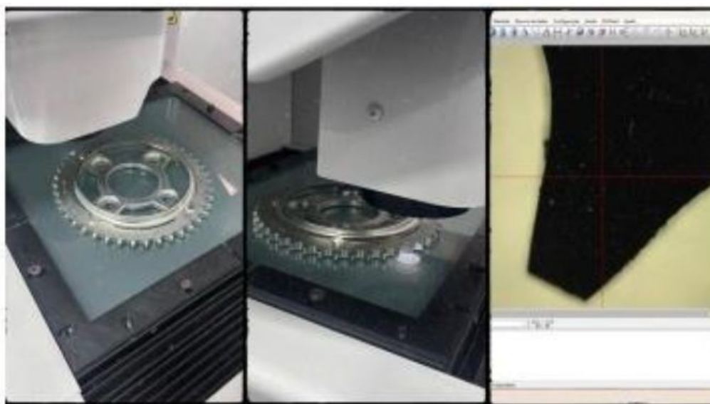
Figura 14 - Detalhamento do processo de medição dimensional: (a) posicionamento da amostra na mesa; (b) detalhe do sensor óptico na zona de medição; (c) interface do software para mapeamento do perfil.
