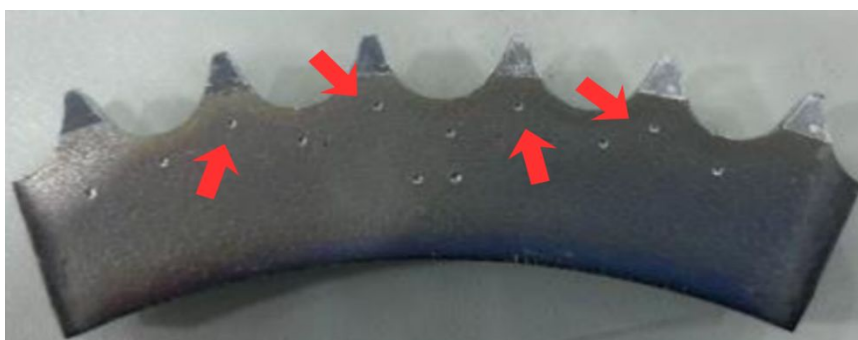
Figura 18 - Face lateral da coroa evidenciando os pontos de indentação para o ensaio de dureza HRB.
