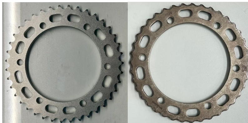
Figura 25 - Comparativo macroscópico da Amostra B: (a) estado inicial; (b) aspecto após o ensaio com severa deformação plástica e rebarbas superficiais.
