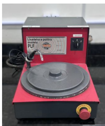
Figura 21 - Lixadeira e politriz metalográfica utilizada no preparo final das superfícies para microscopia.
