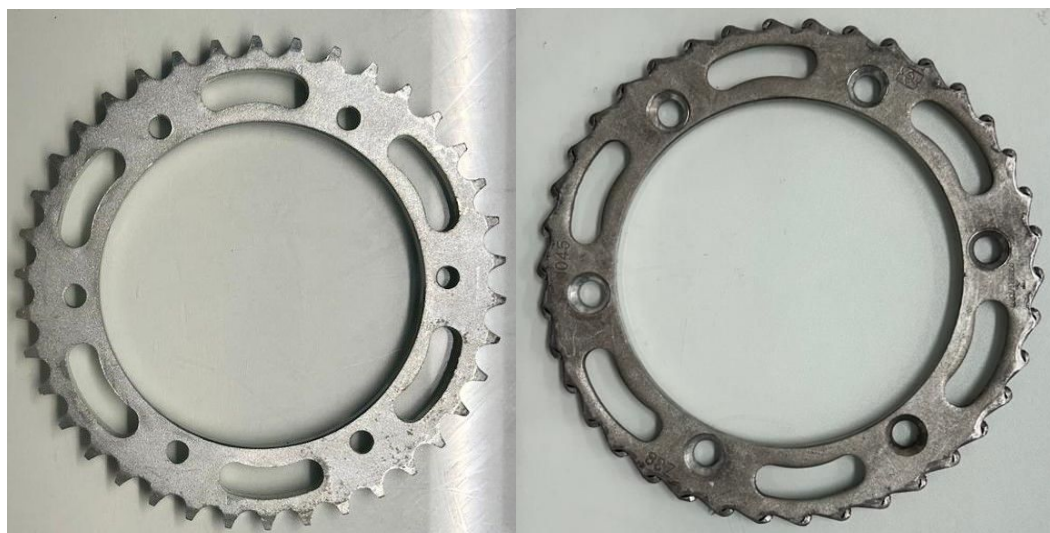
Figura 24 - Comparativo macroscópico da Amostra A: (a) estado inicial; (b) aspecto após o ensaio evidenciando perda de perfil no flanco.
