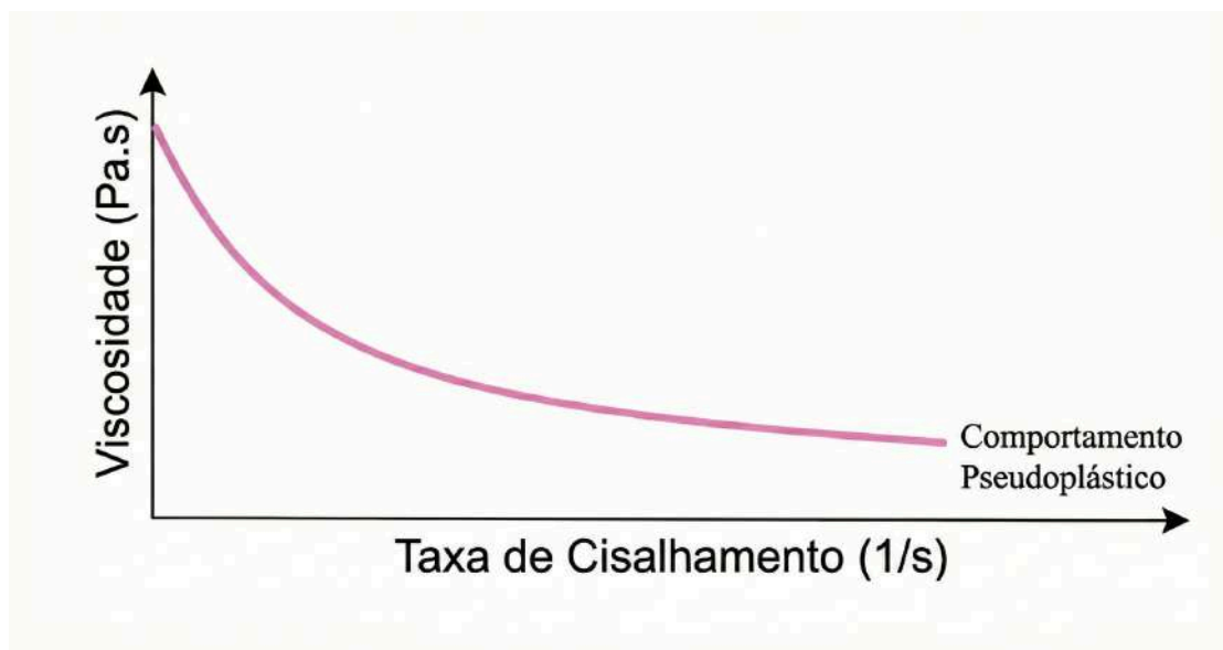
Figura 5 - Curva característica de um fluido pseudoplástico ideal para robocasting .
