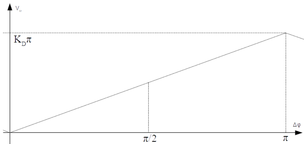
Figura 2 - Tensão de erro em função da diferença de fase entre as entradas
