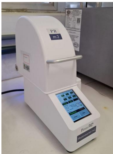
Figura 15 – Fotorreator Penn PhD Photoreactor M2
