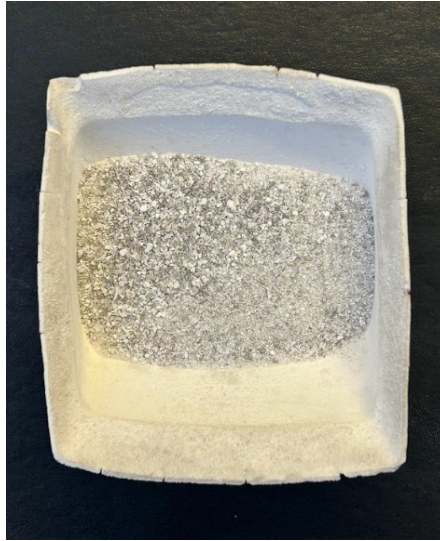
Figura 8 - Pó de biovidro 58S Mesoporoso após calcinação.
