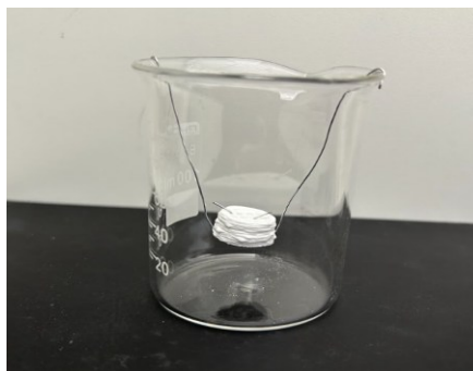
Figura 13 - Esquema do sistema de incorporação das nanopartículas de prata.
