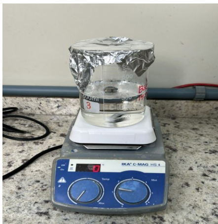
Figura 6 - Soluções preparadas homogeneizadas em misturador magnético.
