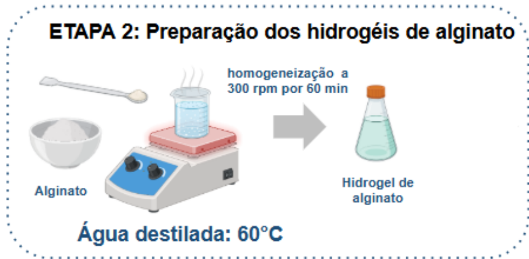
Figura 10 - Ilustração da segunda de fabricação: preparação do hidrogel de alginato de sódio.
