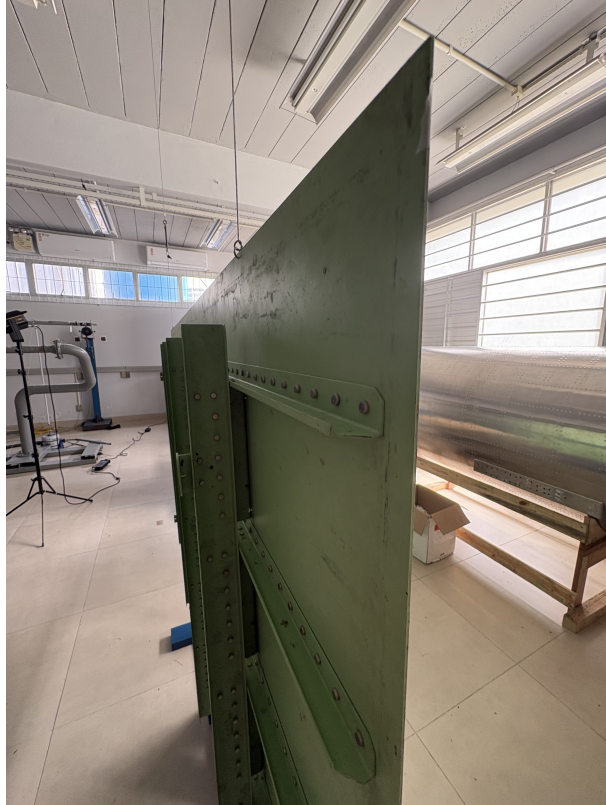
Figura 19 – Placa reforçada suspensa para o ensaio.
