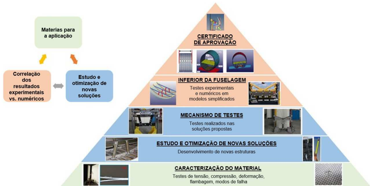
Figura 1 – Abordagem Building Block (Pirâmide de Testes) na validação de estruturas aeronáuticas.
