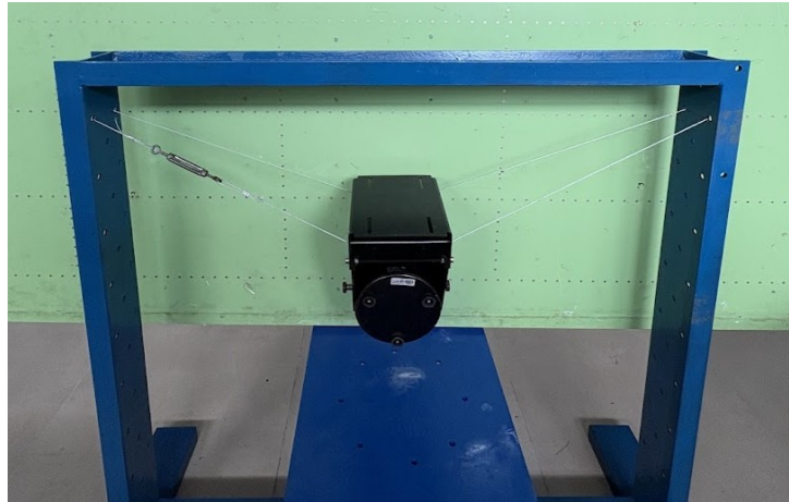
Figura 20 – Instalação do shaker .
